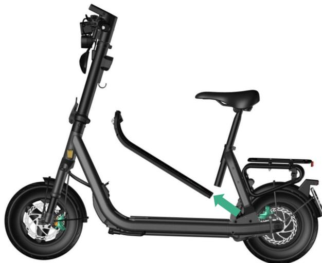
1. Um an den Controller zu gelangen, musst du zunächst das Trittbrett öffnen und abnehmen. Drehe hierfür den Schlüssel vorne am Trittbrett in Uhrzeigersinn.
